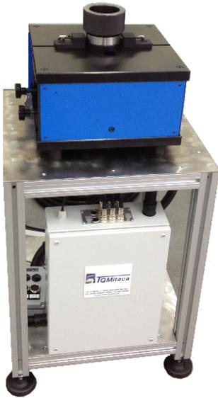
Postazione di controllo 100% fori dischi mozzo con carico scarico con robot.
