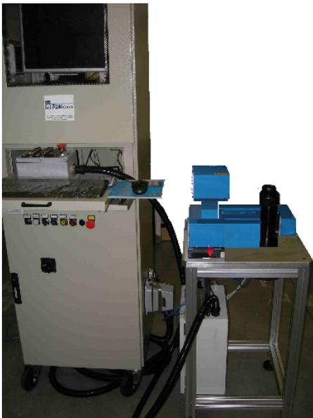
Postazione speciale Itageo 6<sup>®</sup> per il controllo posizione fori dischi mozzo, con testa laser e algoritmo speciale di verifica centratura fori.
