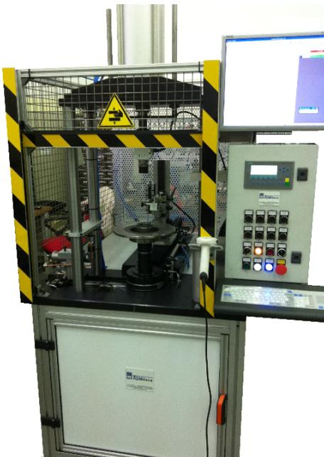
Postazione Itageo 6<sup>©</sup> di controllo dischi mozzo con cuscinetto montato, con applicazione carico su cuscinetto, con software speciale per compensazione errori di rotolamento indotti dal cuscinetto.
