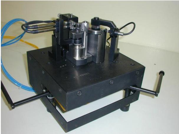
Calibro speciale per controllo bilancieri, con software speciale per controllo raggio di curvatura pattini.
