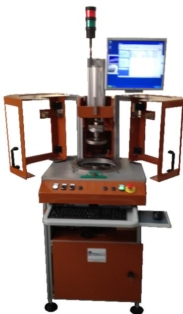
Postazione speciale di collaudo "Forza Spostamento" per dischi freno flottanti, completa di software speciale Itaforce per il calcolo dell'elasticità delle molle di assemblaggio.
