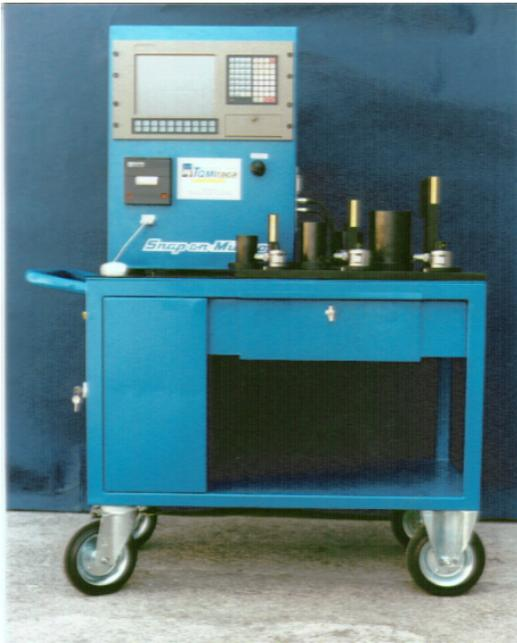
Postazione Itaser mobile di controllo e taratura di chiavi dinamometriche e avvitatori, con PC industriale alimentato a 12 Vcc, batteria, stampante integrata.
