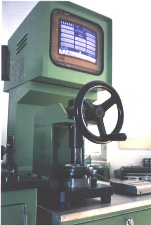
Postazione Itastat per il controllo della resistenza allo spiantaggio di un particolare meccanico.
