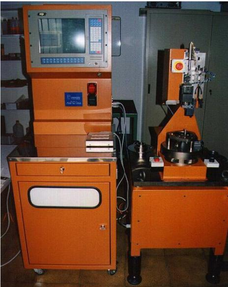
Postazione Itadisk per il controllo al 100% di flange, con caricamento manuale.
