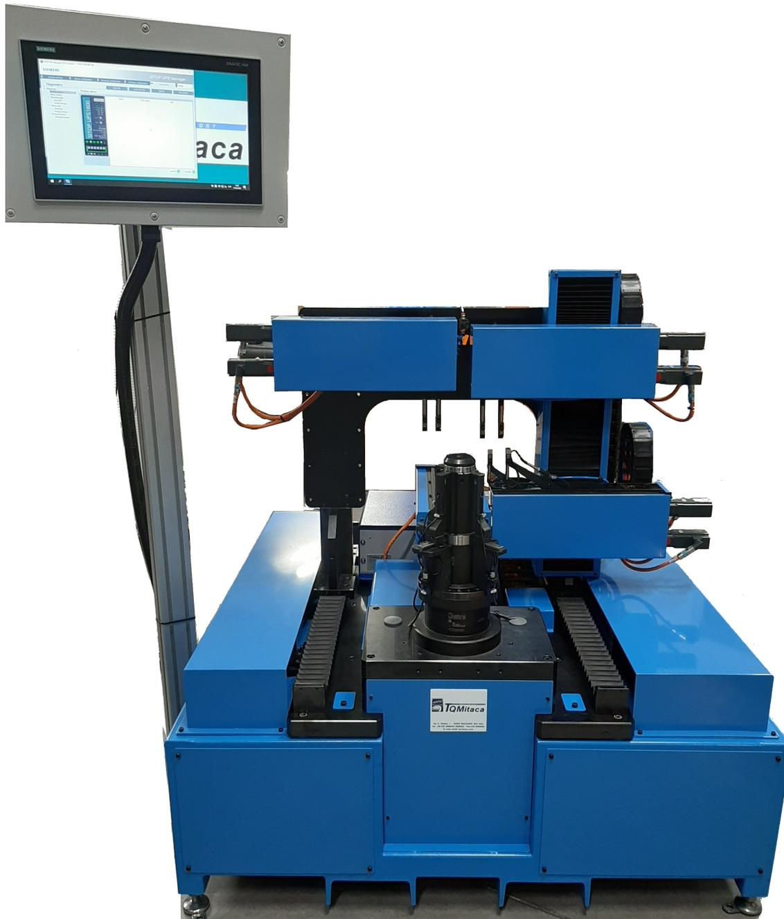
TQM Itaca Technology ha sviluppato un innovativo sistema di misura per dischi freno e tamburi in grado di effettuare il ri-attrezzamento automatico delle sonde di misura.
